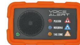
**4- TAG INHIBICIÓN CONDUCTOR:** El conductor nunca se desprende de su tag de vida. Cuando el conductor entra en su carretilla nuestro sistema detecta su tag y lo deja en modo durmiente y sin descargar la batería. Si se baja de la carretilla podrá ser detectado por otras carretillas.
